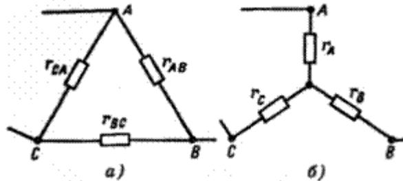
Рисунок 15 - Изображение схемы треугольника и ее эквивалентное преобразование в схему звезда
