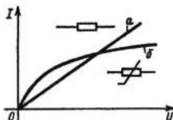
Рисунок 4 - Вольтамперные характеристики (ВАХ) линейных и нелинейных резистивных элементов
