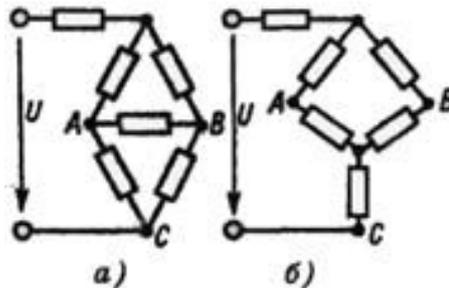
Рисунок 16 - Мостовая схема соединения резистивных элементов и ее эквивалентная схема звездой
