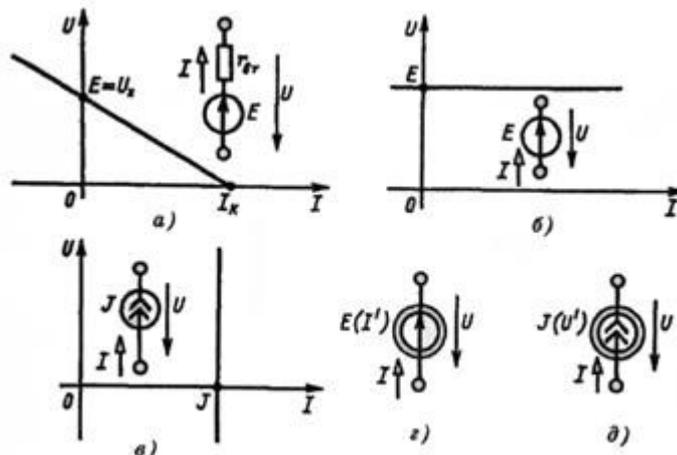
Рисунок 7 -Изображения источников тока и их вольтамперные характеристики
