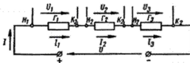
Рисунок 10 - Последовательное соединение резисторов
