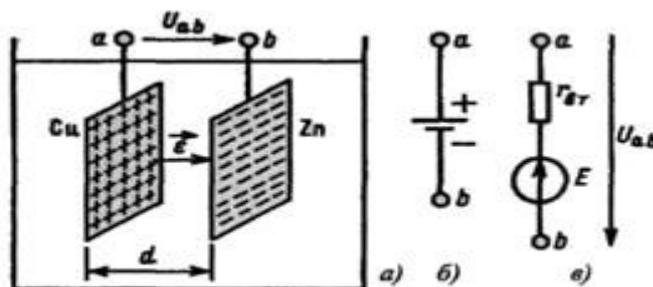
Рисунок 5 - Эскизное изображение гальванического элемента
