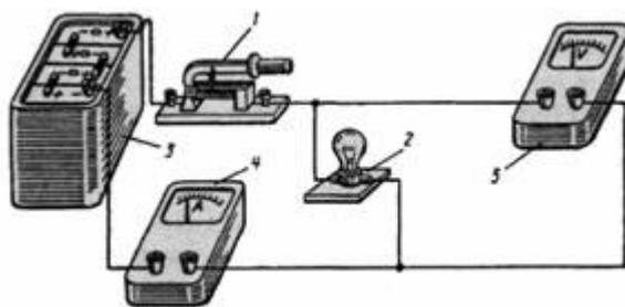
Рисунок 1 - Эскизное изображение электротехнических устройств и способа их соединения в простейшей цепи
