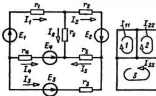
Рисунок 18 - Схема соединения элементов тремя контурами и изображение контурных токов ветвей
