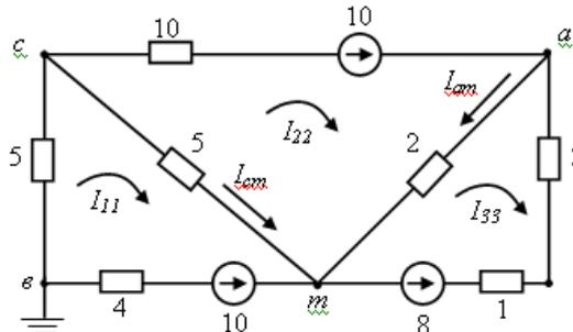
Рисунок 21 - Схема с тремя контурными токами
