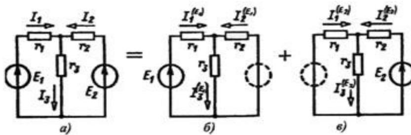
Рисунок 19 - Нахождение токов цепи методом наложения
