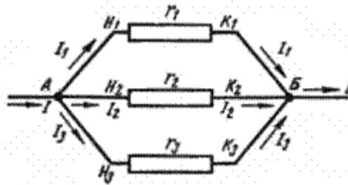
Рисунок 11 - Параллельное соединение резисторов
