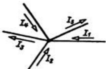
Рисунок 8 - Входящие и выходящие токи
