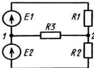
Рисунок 22 - Дифференциальная схема цепи постоянного тока
