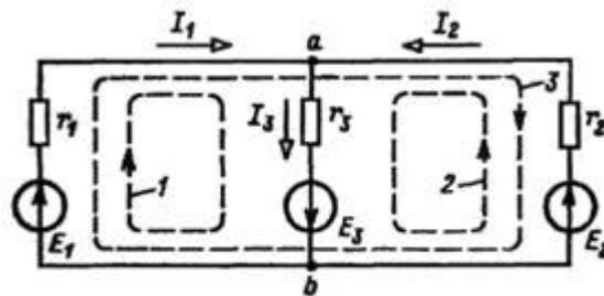
Рисунок 13 - Сложная электрическая цепь
