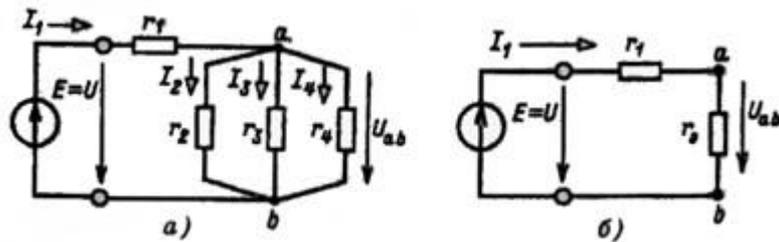
Рисунок 14 - Эквивалентное преобразование электрических схем
