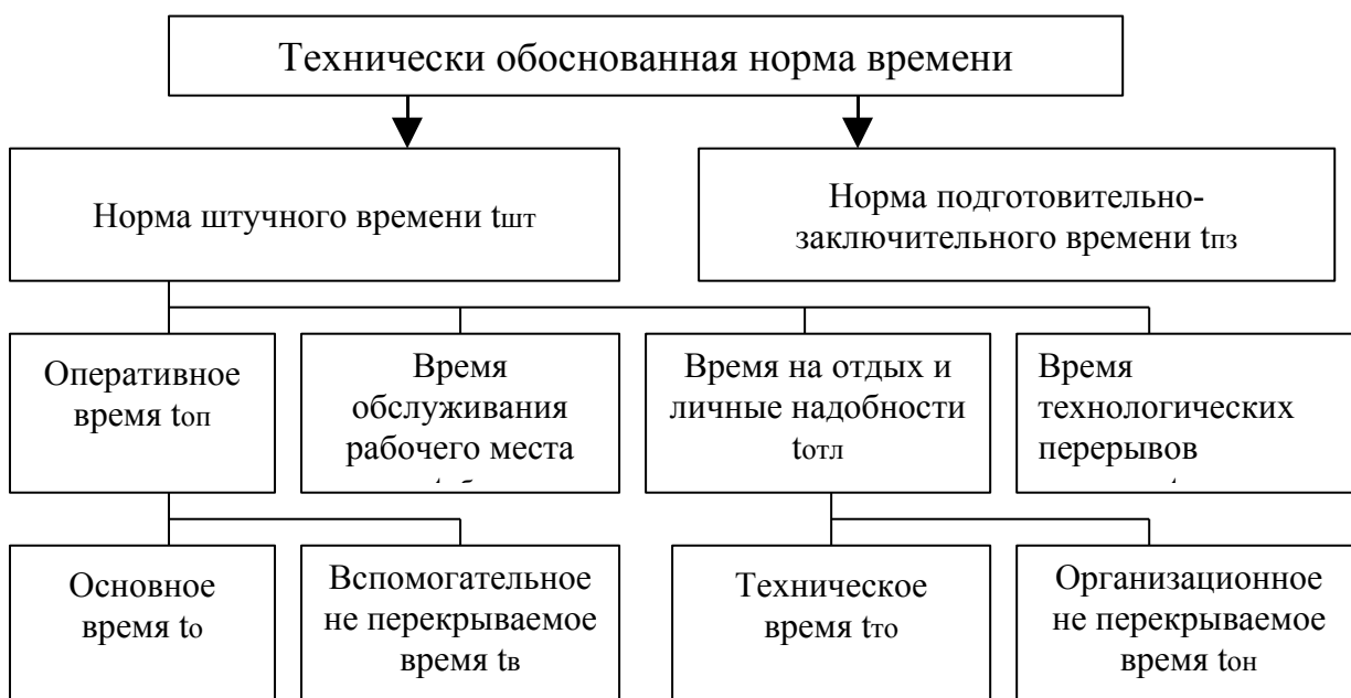
Рисунок 117 - Структура технически обоснованной нормы времени
