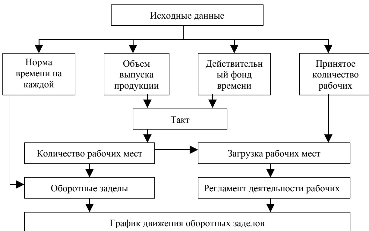
Рисунок 65 - Схема расчета прерывно-поточной линии
