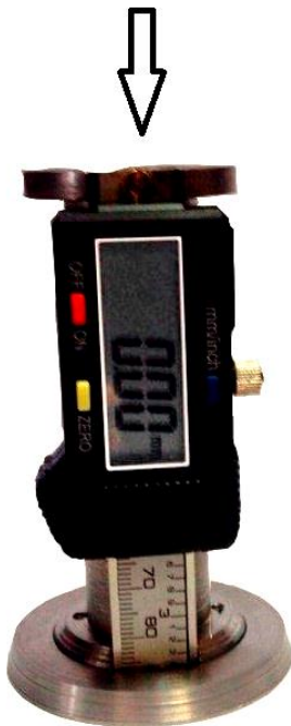
Рисунок 1 - Прибор для определения прочности (плотности) деревянных конструкций полевым методом
