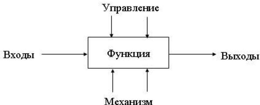
Рисунок 9 – Функциональный блок и интерфейсные дуги
