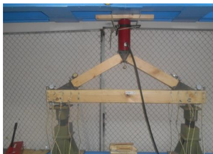
Рисунок 3 - Испытание опорного узла (а) и растянутого стыка (б) на вклеенных в древесину стальных пластинах.
