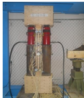
Рисунок 3 - Испытание опорного узла (а) и растянутого стыка (б) на вклеенных в древесину стальных пластинах.
