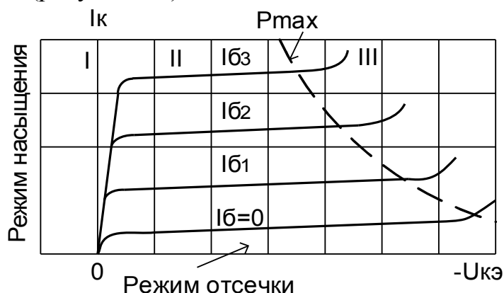
Рисунок 4.2 – Выходные характеристики транзистора с ОЭ
