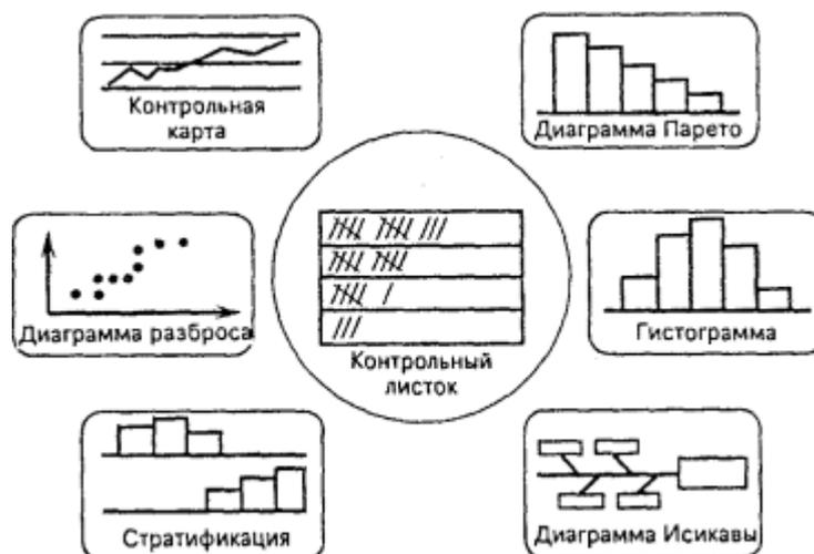
Рисунок 3 - Инструменты контроля качества
