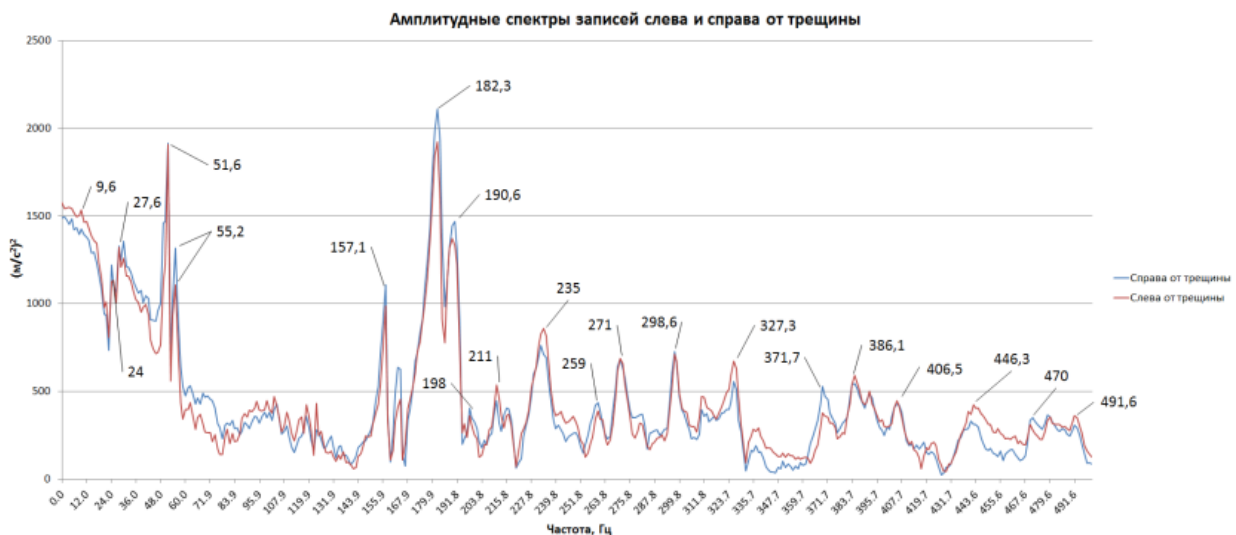
Рисунок 6 - Амплитудные спектры записей слева и справа от трещины
