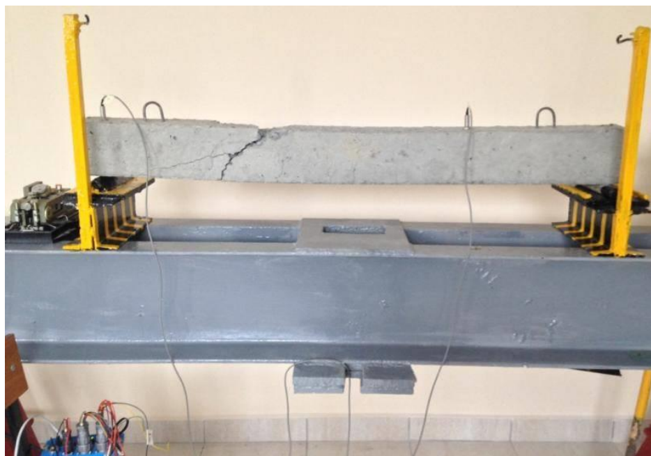
Рисунок 1 -Испытание нарушенной ж/б перемычки.
