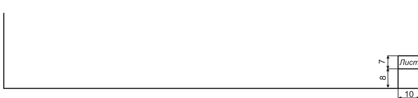
Рисунок А.3 - Форма колонтитула при компьютерном наборе рядовой страницы (по СТП 101-00 приложение К)
