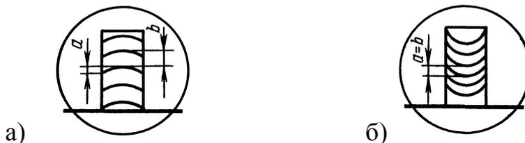
Рисунок 11 – Интерференционные полосы на различных поверхностях
