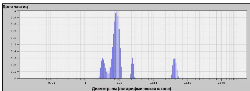
Рис. 6. Распределение частиц магнетита по размерам в растворе, стабилизированном HNO 3 ( c_{\text{HNO}_3} = 0.3 моль/л). Слева на право: 1-ый пик – 11 нм, 2-ой пик – 64 нм.
