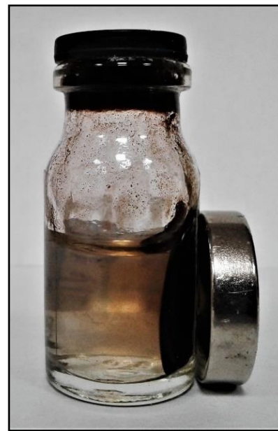
Рис. 2. Микросуспензия нестабилизированных магнитных частиц при действии внешнего магнитного поля.
