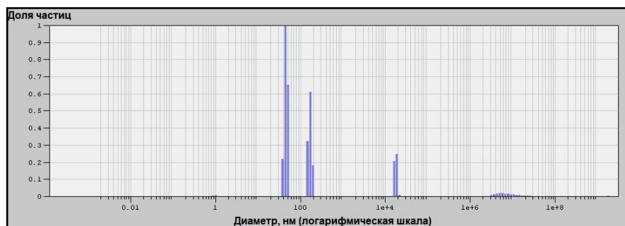
Рис. 5. Распределение частиц магнетита по размерам в растворе, стабилизированном CH_3COOH ( c_{CH_3COOH} = 0.3 моль/л). Слева на право: 1-ый пик – 45 нм, 2-ой пик – 166 нм.
