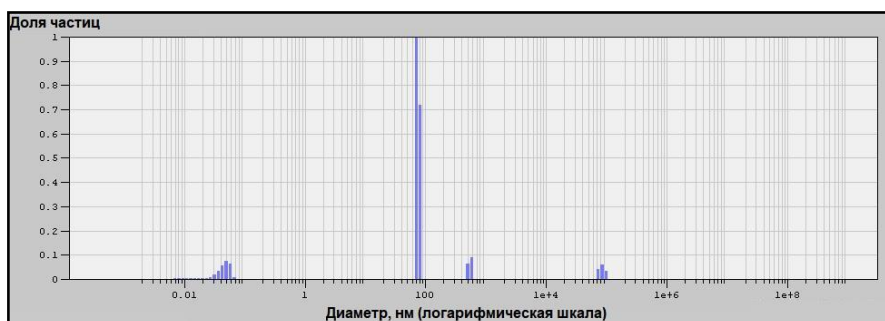
Рис. 8. Распределение частиц магнетита по размерам в растворе, стабилизированном лимон. кисл. ( c_{\text{лим. кисл.}} = 0.3 моль/л). Слева на право: 2-ой пик – 73 нм.
