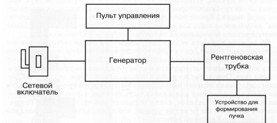
Рисунок 3.1- Схема рентгеновской установки
