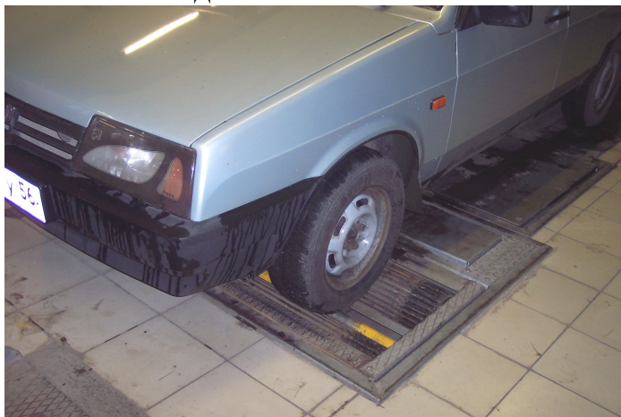
Рисунок 4 – Установка оси на роликах стенда
