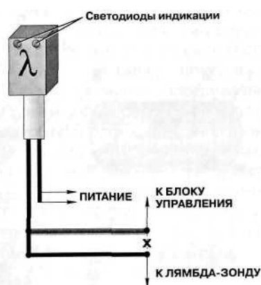
Рисунок 5 - Внешний вид и схема подключения эмулятора лямбда-зонда
