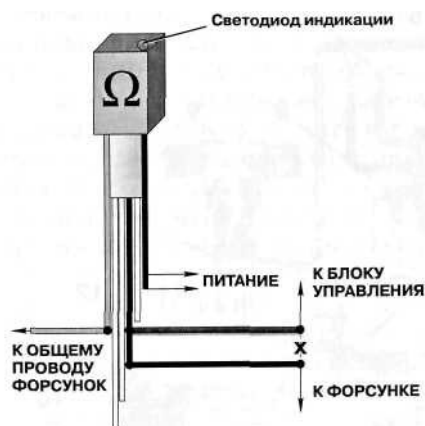
Рисунок 4 - Внешний вид и схема подключения эмулятора форсунок
