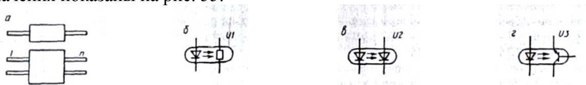
Оптроны (а) и условные графические обозначения резисторных (б), диодных, тиристорных (в), транзисторных (г) оптопар - рисунок 55
