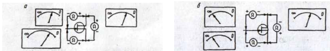
Показания омметра при исправном полевом транзисторе с р-п переходом в случае измерения прямых (а) и обратных (б) сопротивлений перехода – рисунок 66
