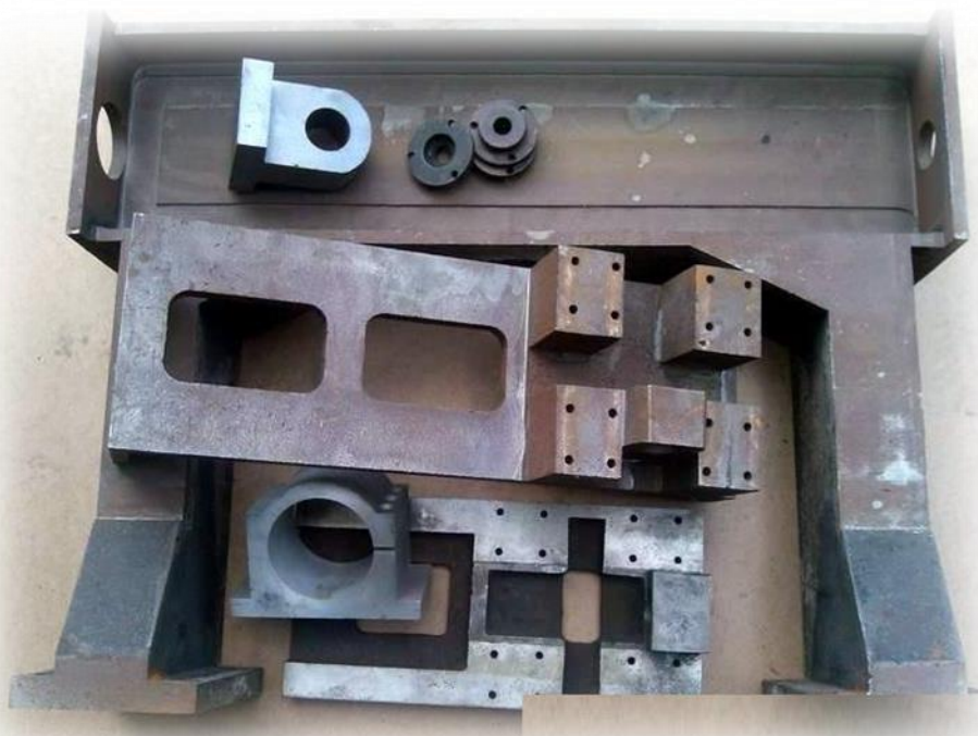
Рисунок 1 - Пример базовых деталей из чугуна
