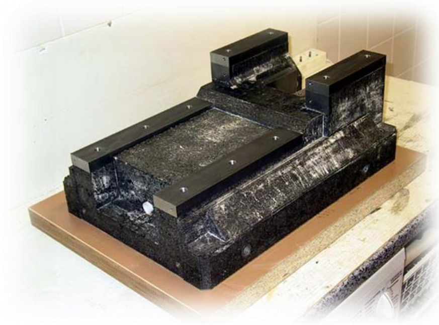
Рисунок 4 - Пример станины из полимергранита
