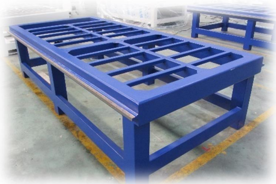
Рисунок 2 - Пример станины из углеродистой стали
