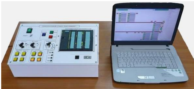
Рисунок 4 – Типовые комплекты учебного оборудования «ПЛК-Siemens» производства компаний ООО «Профкабинет» и «Профистенд»
