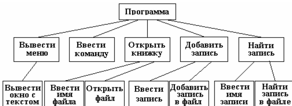
Рисунок 2 - Структурная схема программного продукта (процедурная декомпозиция)
