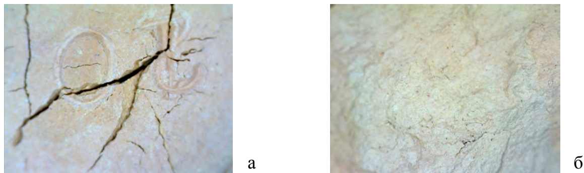
Рисунок 2 – В + водный раствор желатина, \Delta T = 600 °С: макротрещины, x5 (а) и структура образца, x20 (б)
