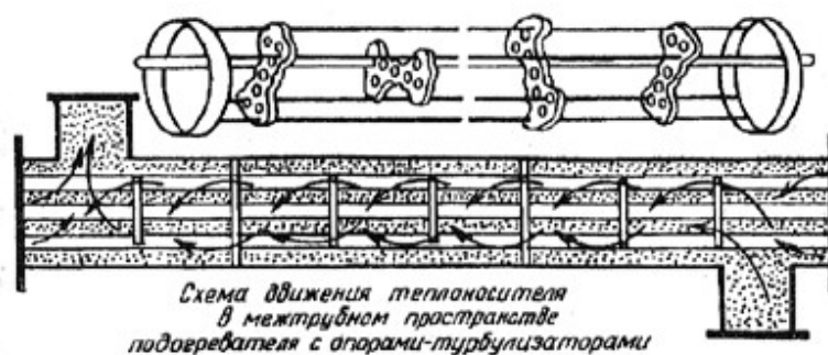
Рисунок 4 – Схема движения теплоносителей в межтрубном пространстве
