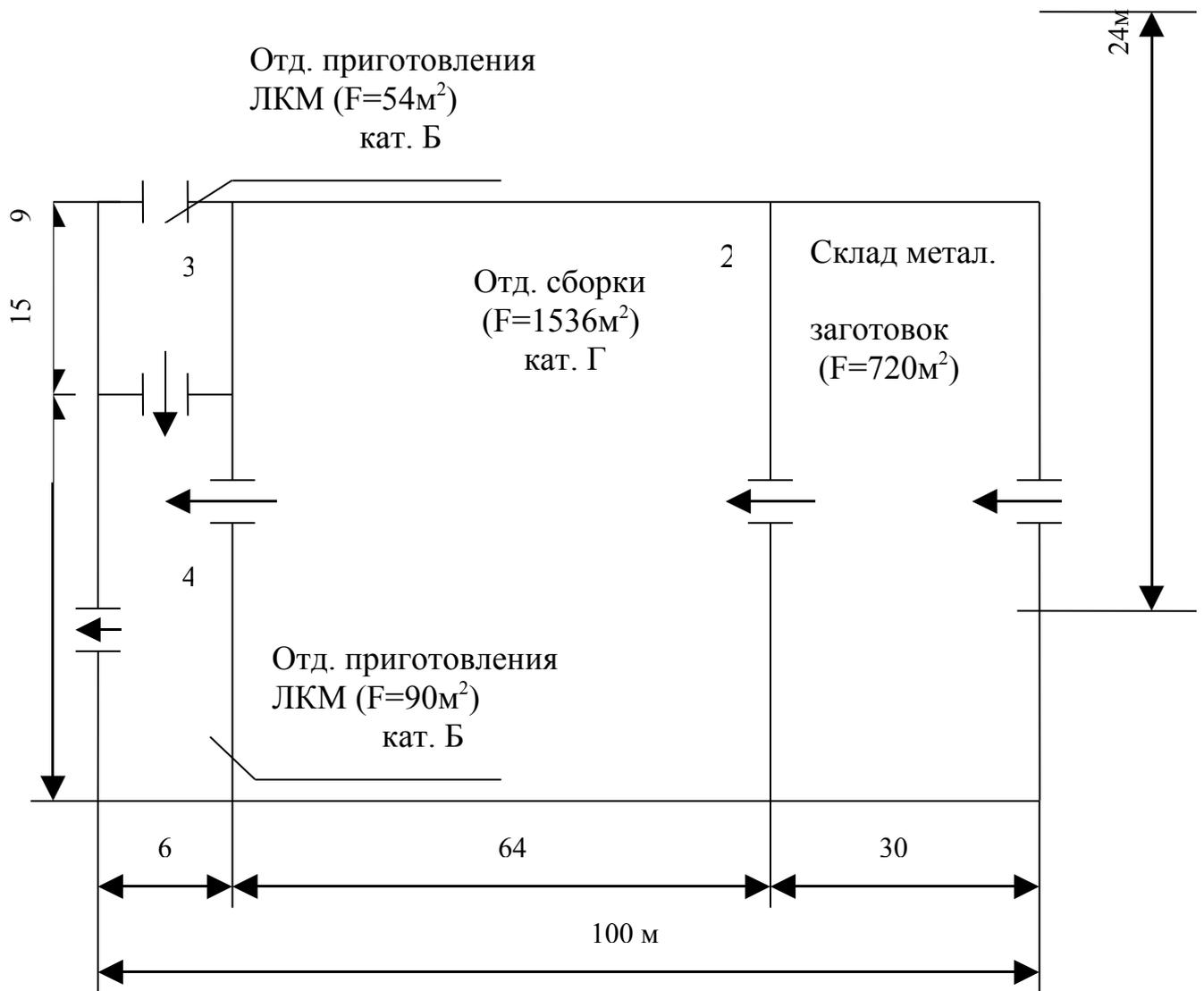
Рисунок 5.1 - План и основные помещения производственного здания, перефилируемого для размещения сборочного производства
