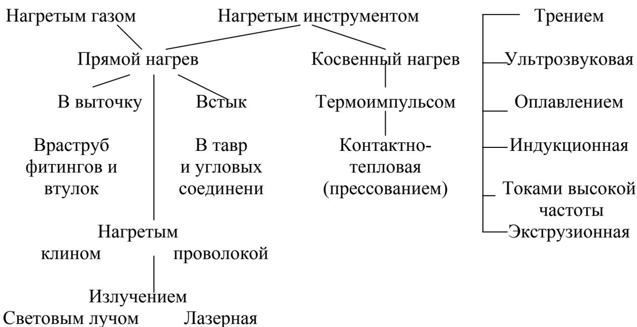
Рисунок 126 – Схема способов сварки труб из термопластичных материалов
