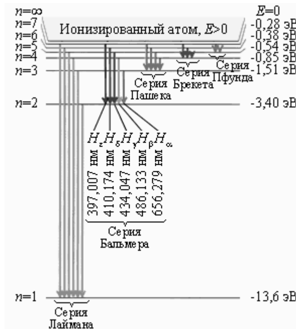
Рисунок 3.8 – Диаграмма энергетических уровней атома водорода. Показаны переходы, соответствующие различным спектральным сериям. Для первых пяти линий серии Бальмера в видимой части спектра указаны длины волн
