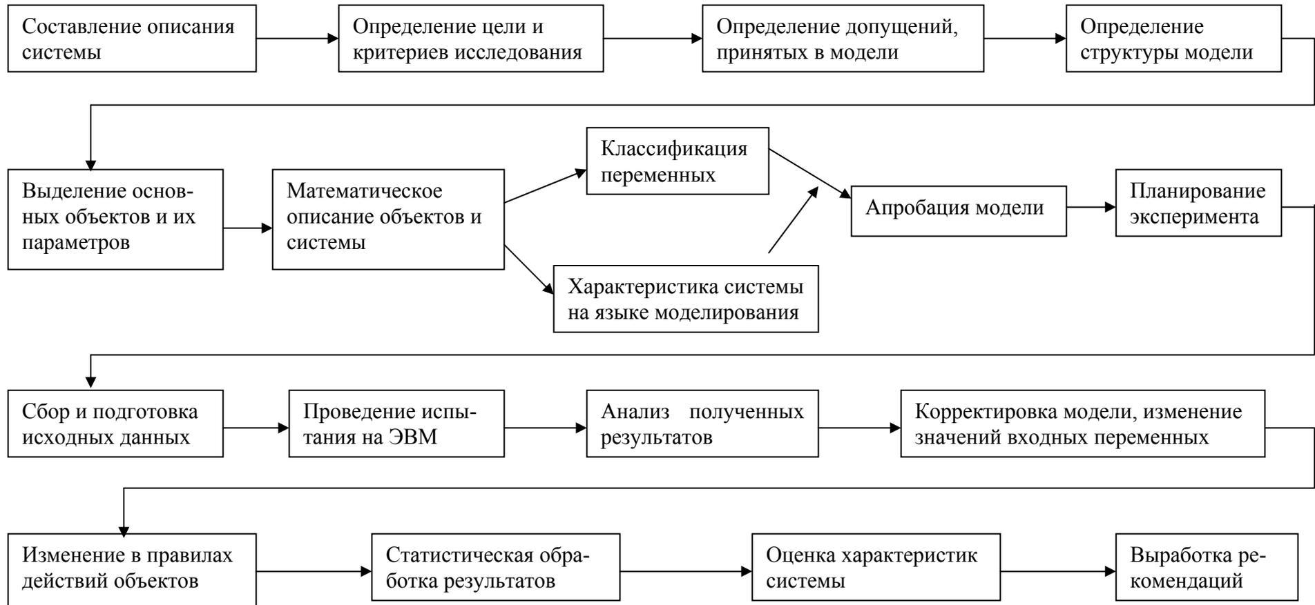
Рисунок III.1 – Схема этапов выполнения исследования в имитационном моделировании
