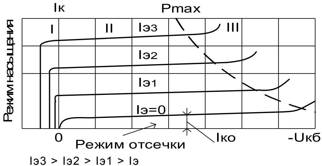
Рисунок 5.5 – Выходные характеристики транзистора с ОБ
