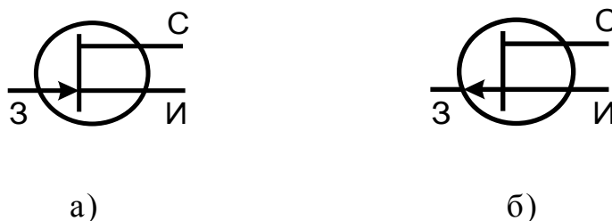
Рисунок 7.1 - Условное обозначение транзистора а) с р-п-переходом и каналом n-типа, б) с р-п-переходом и каналом p-типа
