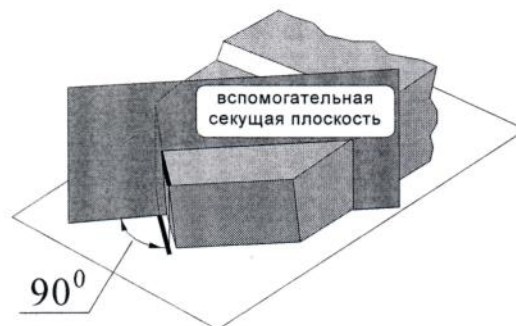
Рисунок 23 – Вспомогательная секущая плоскость токарного резца
