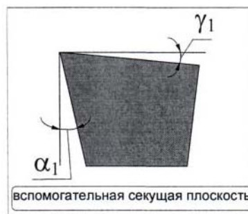
Рисунок 25 – Вспомогательный задний угол \alpha_1
