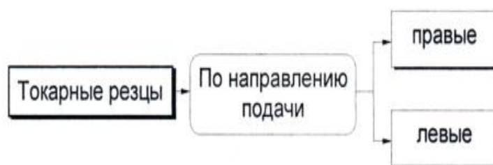
Рисунок 40 – Направление подачи резца
