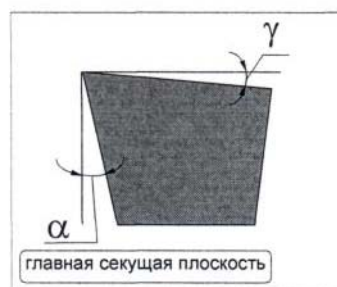
Рисунок 21 – Задний угол главной секущей плоскости резца
