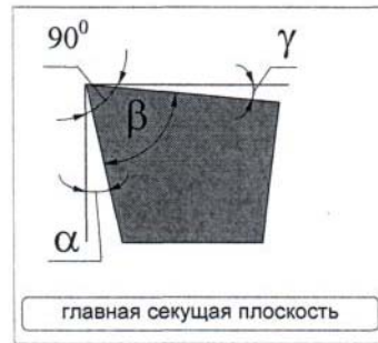
Рисунок 22 – Угол заострения токарного резца
