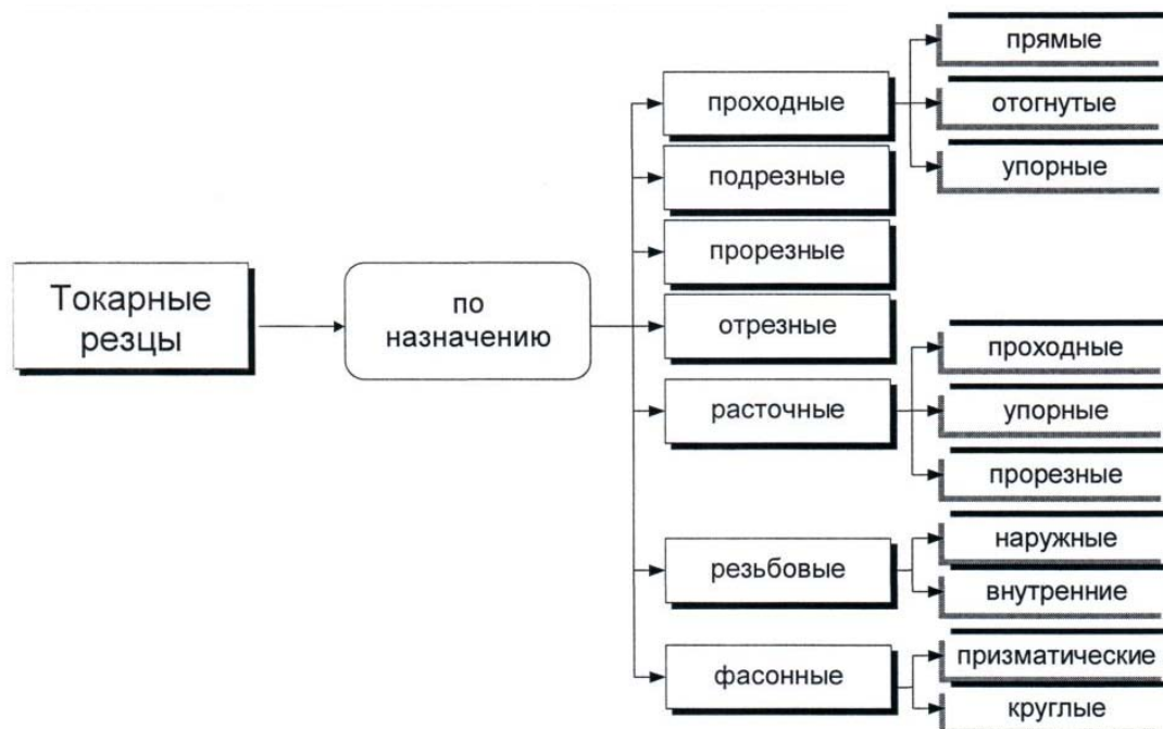
Рисунок 33 – Классификация токарных резцов по назначению
