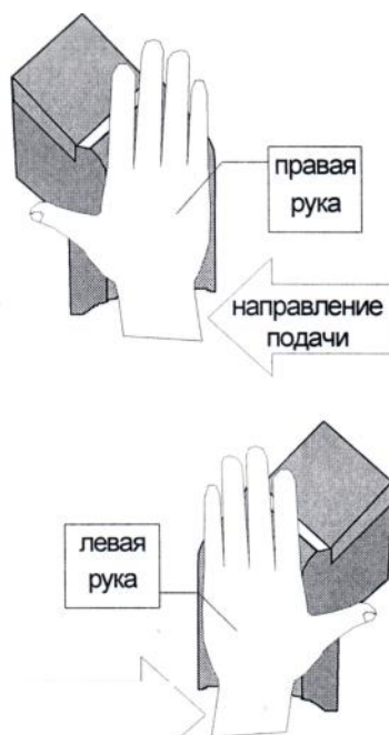
Рисунок 41 – Тип резцов по направлению подачи
