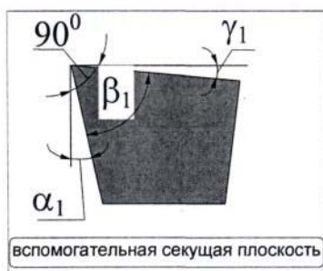
Рисунок 26 – Вспомогательный угол заострения \beta_1
