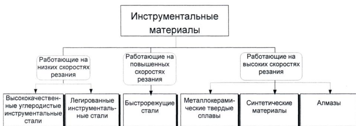
Рисунок 8 – Классификация инструментальных материалов
