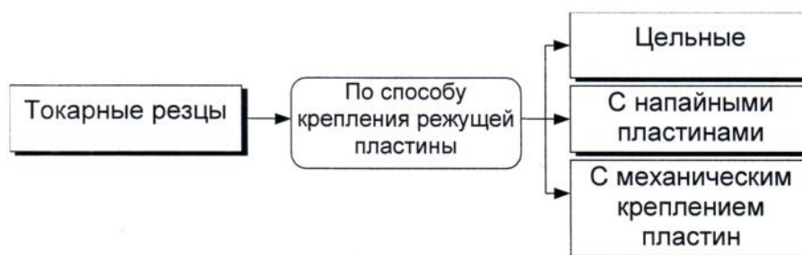
Рисунок 37 – Способы крепления режущей пластины
