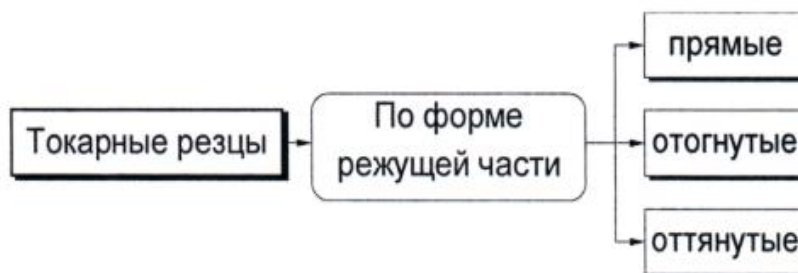
Рисунок 38 – Формы режущей части резца
