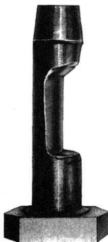
Рисунок 6 — Болт крепления коллектора авиационного поршневого двигателя, поврежденной вследствие окислительного изнашивания
