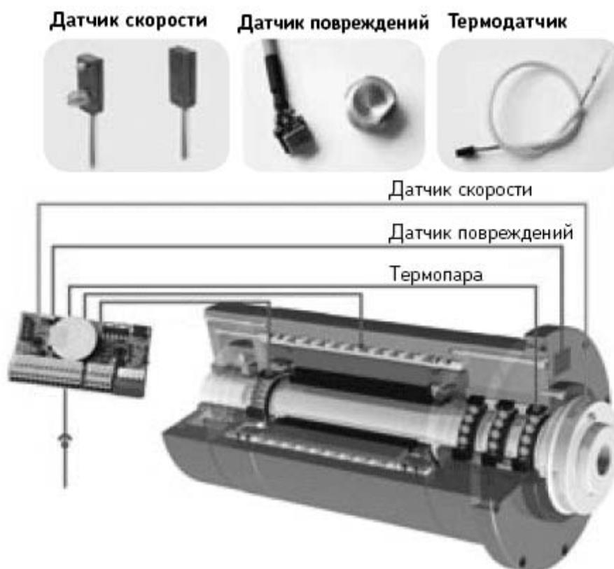
Рисунок 15 – Пример использования системы обнаружения повреждений ШУ
