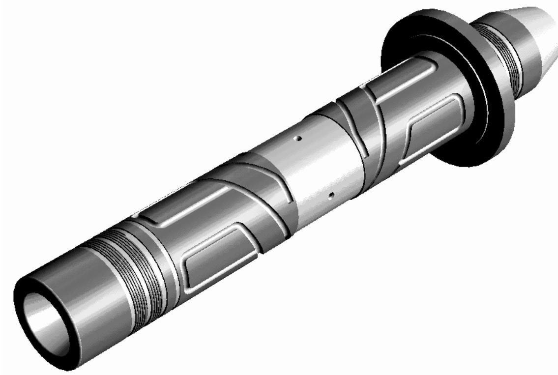
Рисунок 17 – Общий вид скоростного шпинделя на самокомпенсирующихся гидростатических опорах
