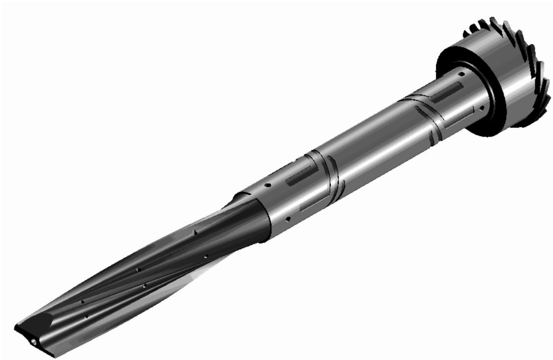
Рисунок 16 – Общий вид шпинделя-инструмента
