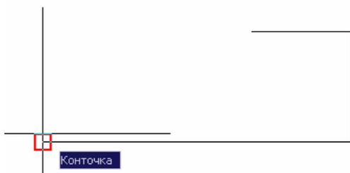
Рисунок 2.13 – Привязка к левой крайней точке основания
