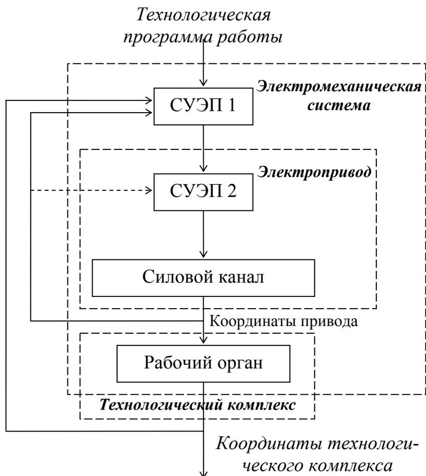
Рисунок 1.1 - Структурная схема электромеханической системы технологического комплекса
