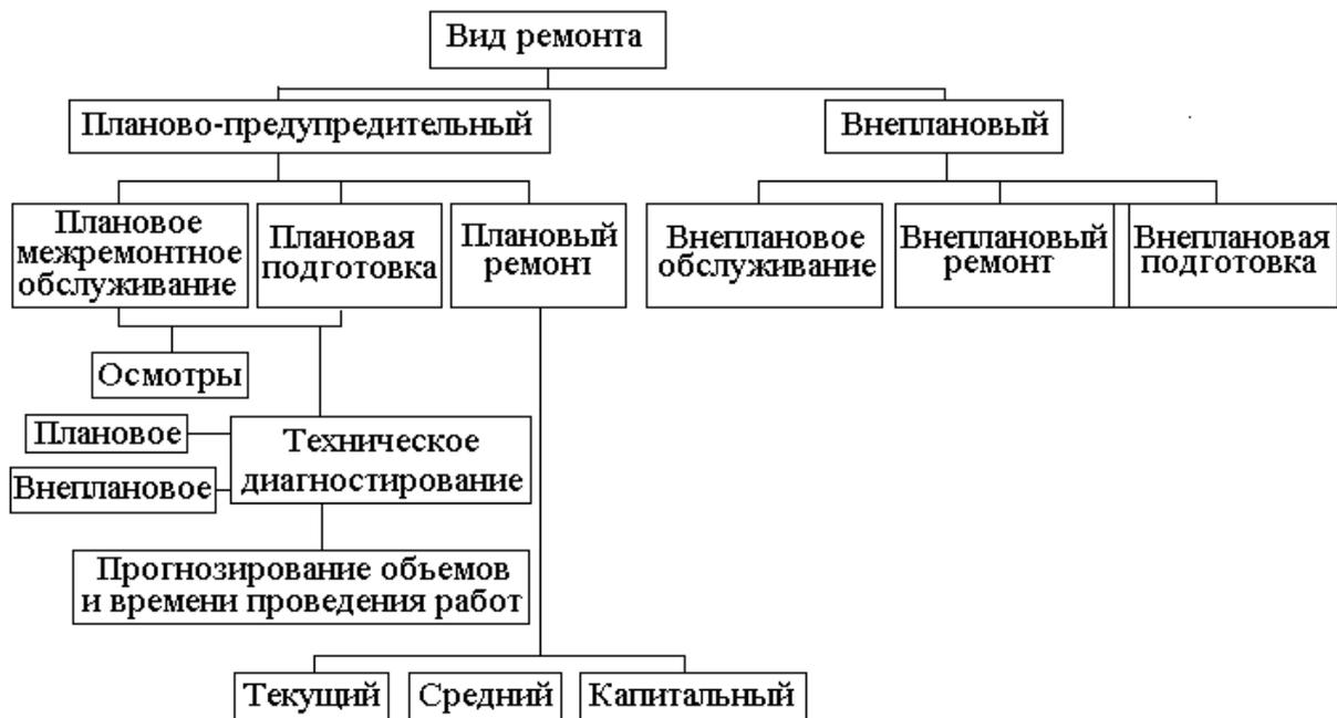
Рисунок 1.2 - Структура ремонтных работ
