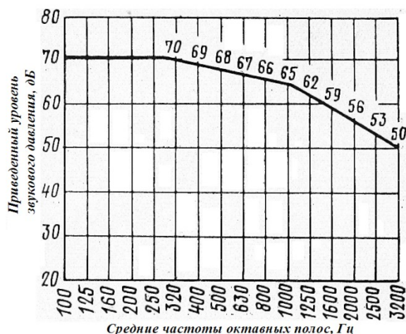
Рисунок 4.26 - Нормативная частотная характеристика приведенного уровня ударного шума под перекрытием
