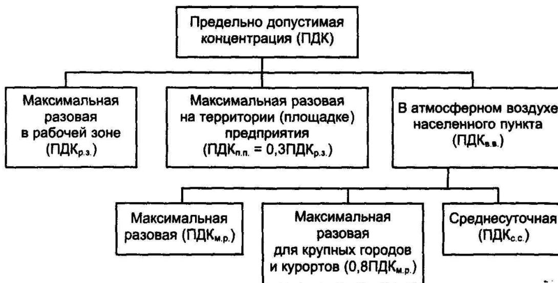
Рисунок 2.1 Классификация предельно допустимых концентраций
