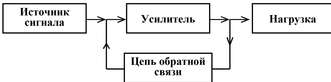
Рисунок 6.1 – Схема усилителя, охваченного цепью обратной связи
