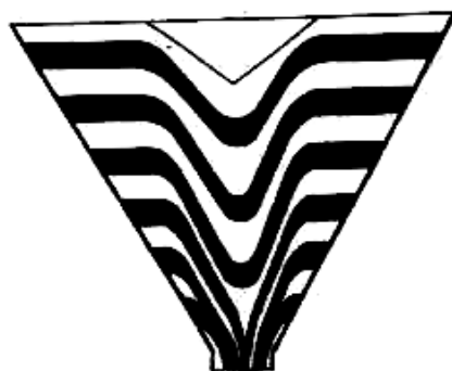
Рисунок 45 - Движение сыпучих материалов в бункерах
