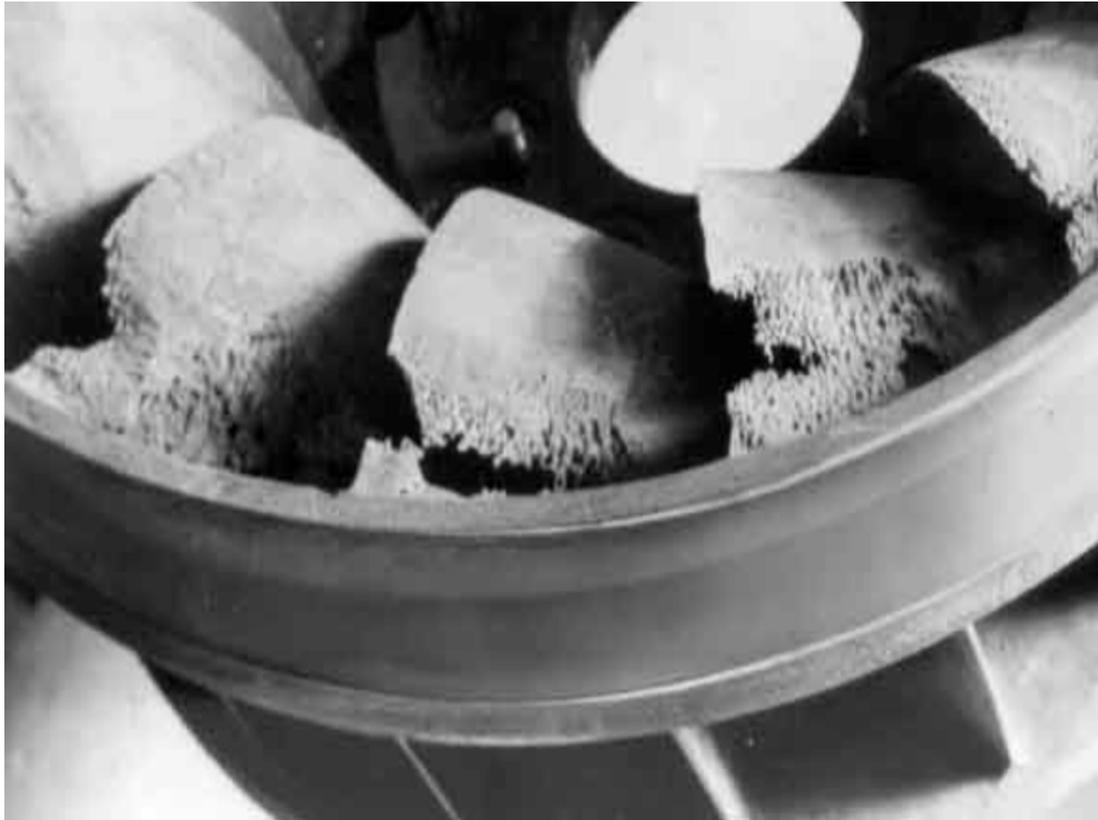
Рисунок 2 – Кавитационная эрозия на рабочем колесе центробежного насоса.
