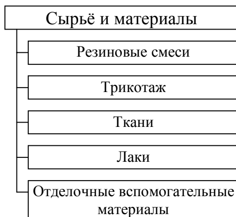
Рисунок 66 – Сырьё и материалы, применяемые при изготовлении резиновой обуви
