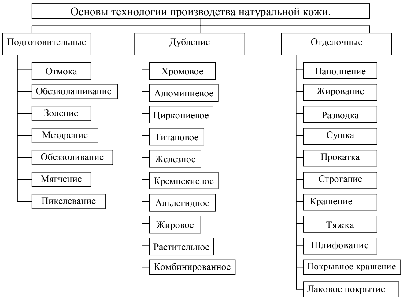
Рисунок 12 - Основы технологии производства натуральной кожи
