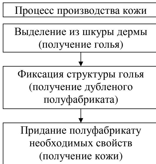
Рисунок 11 – Основные этапы производства натуральной кожи
