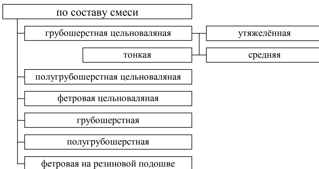
Рисунок 74 – Классификация валяной обуви по составу смеси
