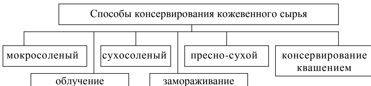
Рисунок 10 – Способы консервирования кожевенного сырья
