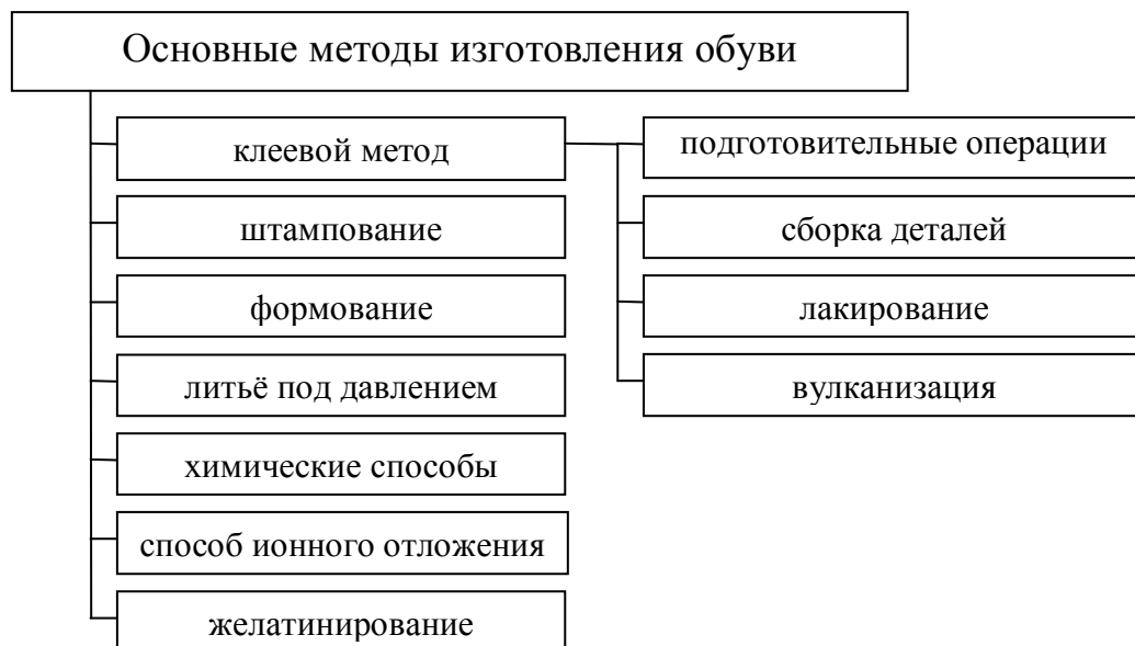
Рисунок 68 – Основные методы изготовления обуви
