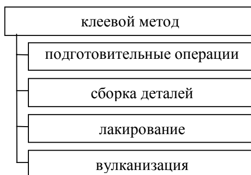
Рисунок 69 – Клеевой метод изготовления резиновой обуви
