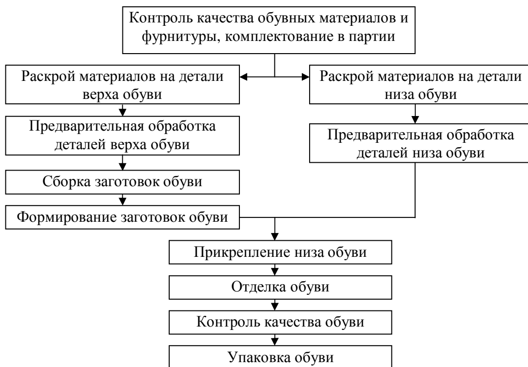
Рисунок 34 – Схема производства кожаной обуви
