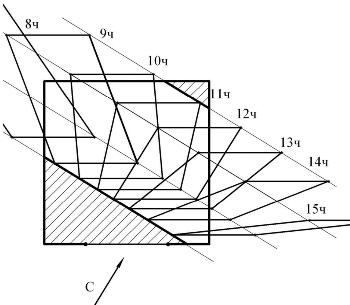
Рисунок 3.8 – Определение зоны инсоляции в помещении (М 1:50)
