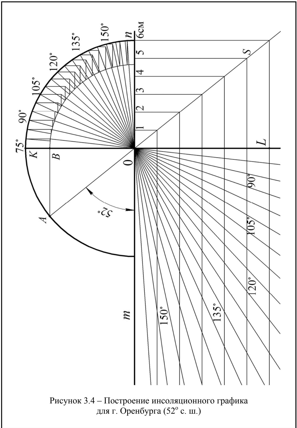
Рисунок 3.4 – Построение инсоляционного графика для г. Оренбурга (52° с. ш.)
