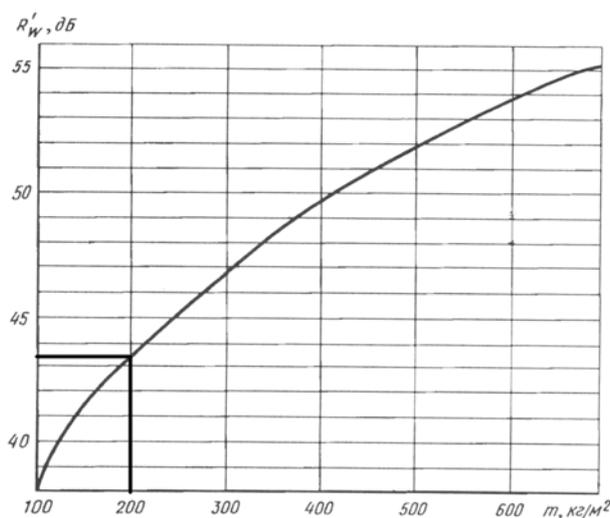
Рисунок 3.18 – Определение индекса изоляции воздушного шума
