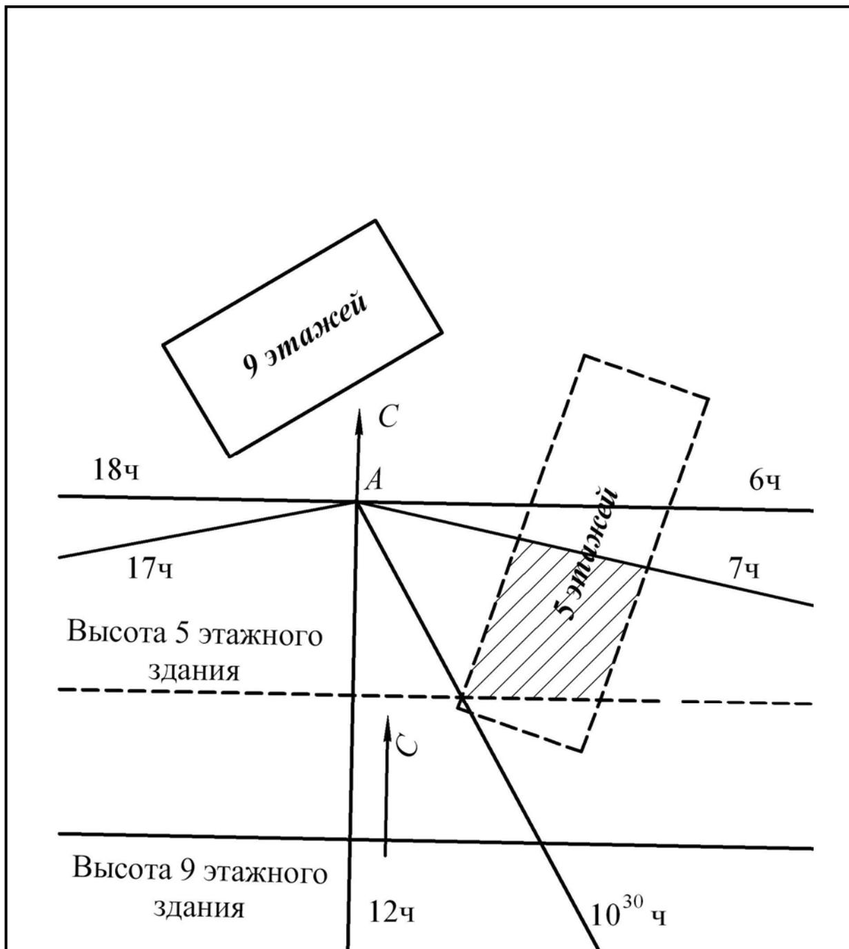
Рисунок 3.6 – Определение продолжительности инсоляции (М 1:500)
