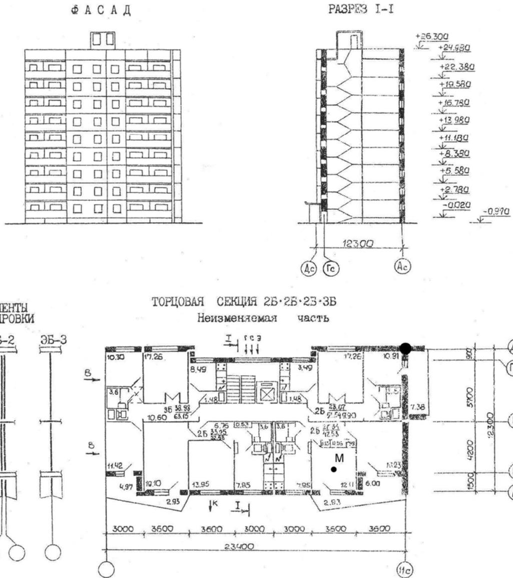
Рисунок 3.3 – Фасад и план типового этажа (М 1:300)
