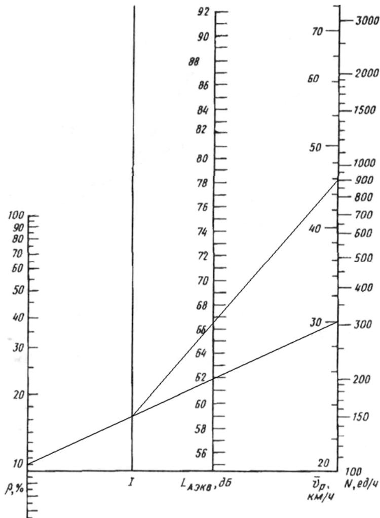
Рисунок 3.15 – Определение шумовой характеристики автомобильного транспорта
