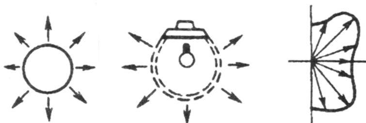
Рисунок 3.13 - Схема распределения света, схема светильника и кривая светораспределения
