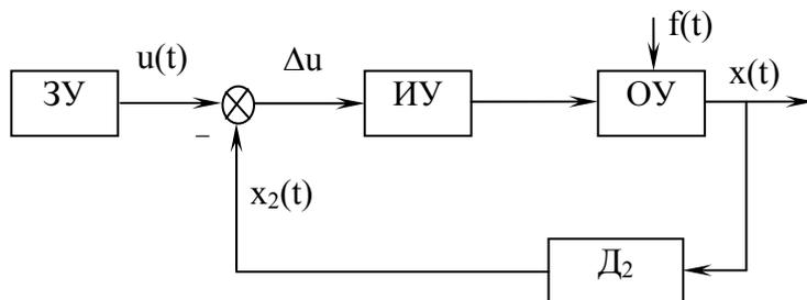
Рисунок 2.10 –Функциональная схема управления по отклонению
