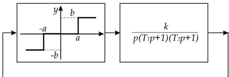
Рисунок 6.16 – Структурная схема релейной системы к примеру 6.2
