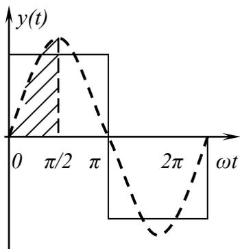
Рисунок 6.14 – Графики выходного сигнала идеального реле и его первой гармоники ряда Фурье
