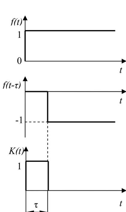
Рисунок 5.2 - Формирование прямоугольного импульса
