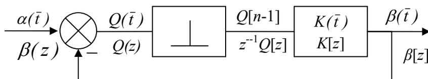
Рисунок 5.6 – Простейшая структурная схема замкнутой СИР
