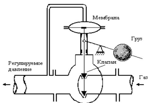
Рисунок 2.6 – Принципиальная схема регулятора давления газа
