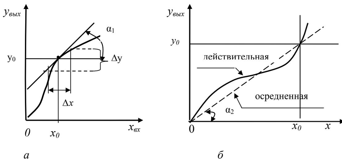
Рисунок 3.1 – Статические характеристики нелинейных элементов САУ
