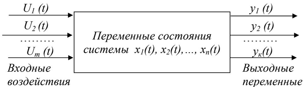
Рисунок 4.2 – Математическая модель САУ через переменные состояния
