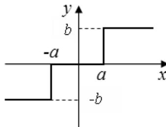
Рисунок 6.9 – Статическая характеристика релейного элемента с зоной нечувствительности
