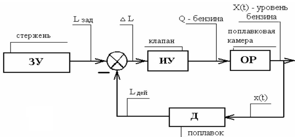
Рисунок 2.4 – Функциональная схема системы к примеру 2.1
