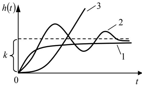
Рисунок 3.4 – Графики переходных функций
