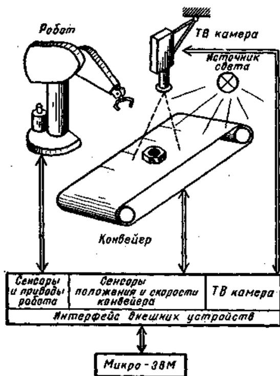
Рисунок 7.13 – Схема работы робота с телевизионным визуальным очувствлением
