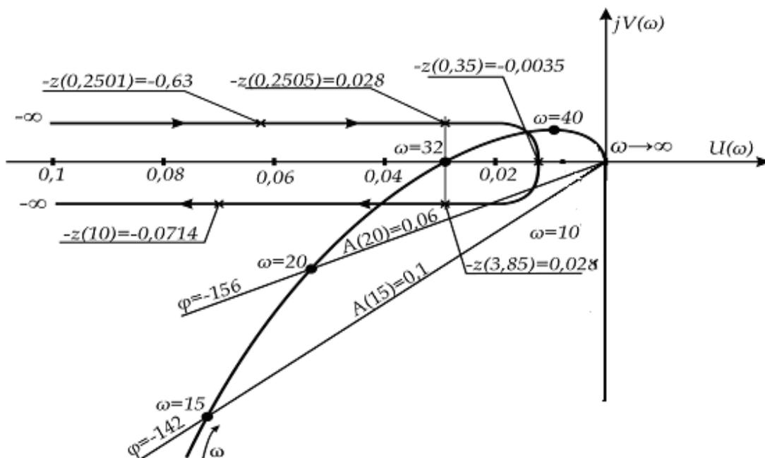
Рисунок 6.17 – АФЧХ линейной части системы и  $Z(A)$  к примеру 6.2
