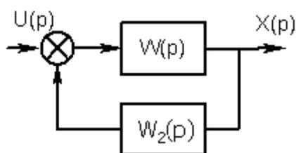
Рисунок 4.6 – Включение корректирующего звена в местную обратную связь
