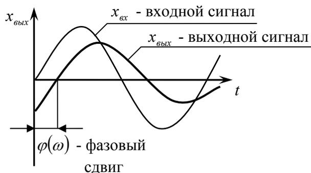
Рисунок 3.9 – Гармонический сигнал на входе и выходе линейной системы
