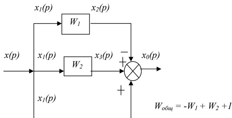
Рисунок 3.17 – Получение общей ПФ параллельно соединённых звеньев
