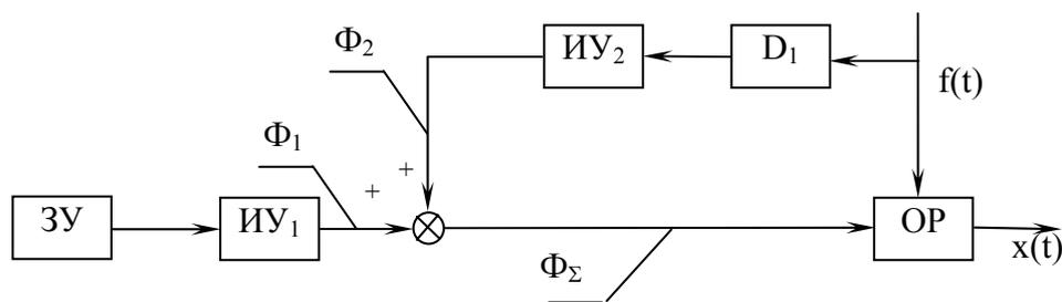
Рисунок 2.9 – Функциональная схема регулирования по возмущению с двумя исполнительными устройствами
