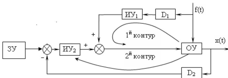
Рисунок 2.11 – Функциональная схема комбинированного управления
