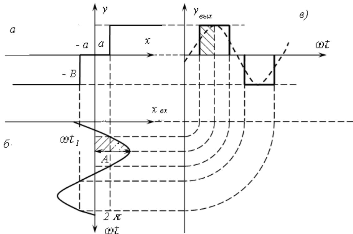
Рисунок 6.13 – К определению гармонической передаточной функции релейного элемента с зоной нечувствительности
