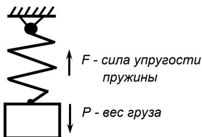
Рисунок 3.14 - Колебание груза подвешенного на пружине
