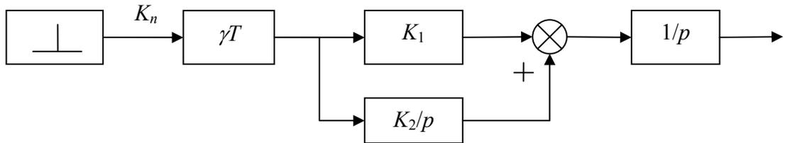
Рисунок 5.5 - Структурная схема СИР к примеру 5.2
