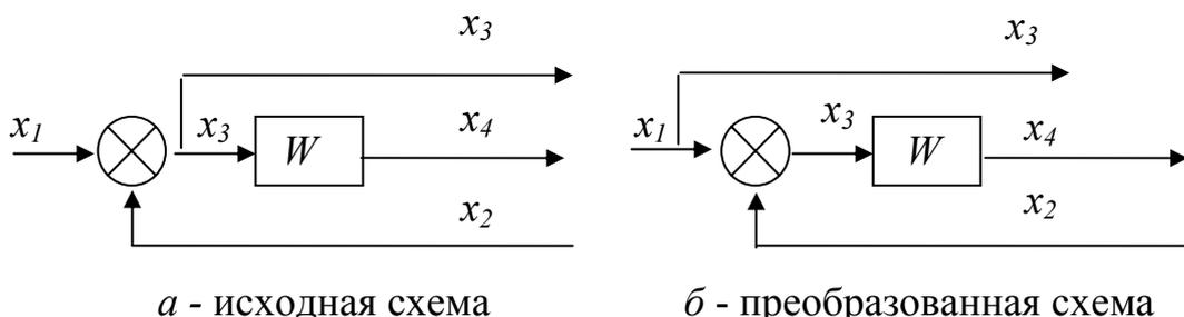
Рисунок 3.20 - Неправильное преобразование сумматора и узла разветвления. Схемы а и б не адекватны
