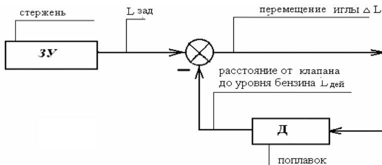
Рисунок 2.3 – Схема работы сравнивающего устройства к примеру 2.1
