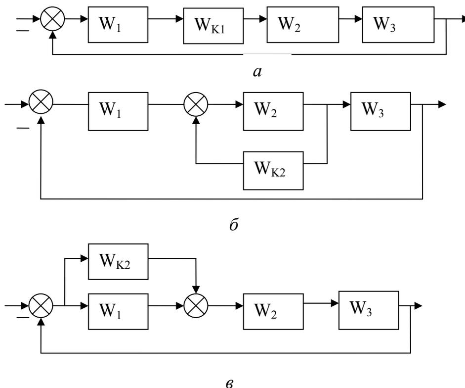
а - последовательное включение; б - включение в обратной связи; в - параллельное включение.
