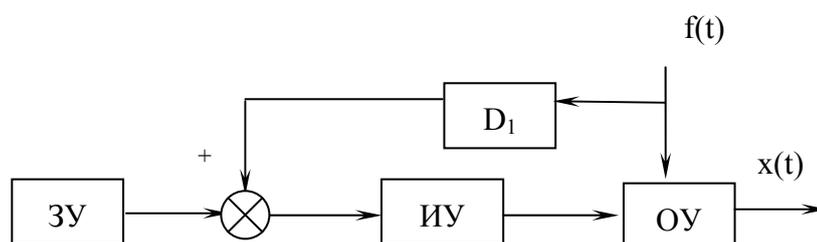
Рисунок 2.8 – Функциональная схема управления по возмущающему воздействию
