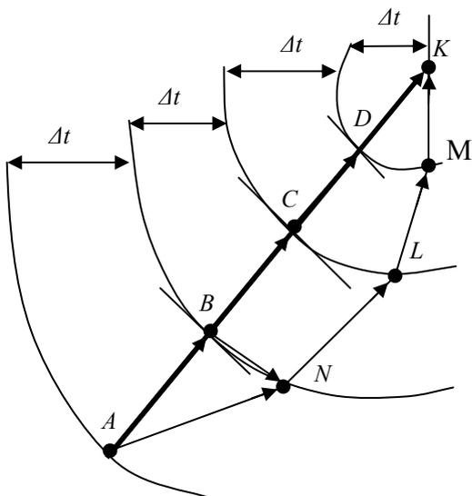
Рисунок 7.3 – Геометрическая интерпретация оптимальной траектории движения системы по принципу максимума Понтрягина
