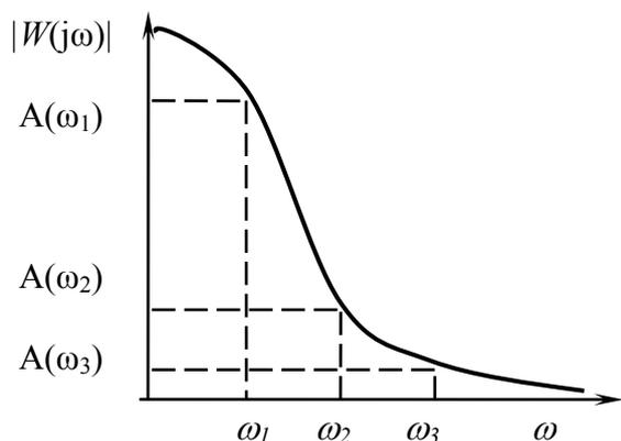
Рисунок 6.12 – Амплитудная характеристика линейной части системы (ЛЧ)
