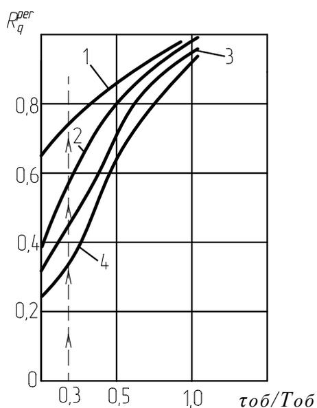
Рисунок 4.7 – Динамический коэффициент регулятора для объектов с самовыравниванием и до 20 % перерегулирования
