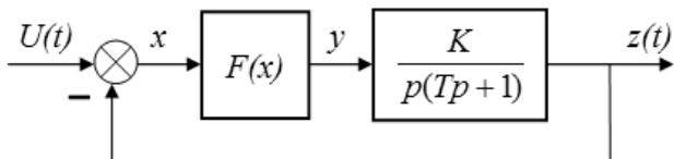
Рисунок 6.8 – Структурная схема релейной следящей системы к примеру 6.1
