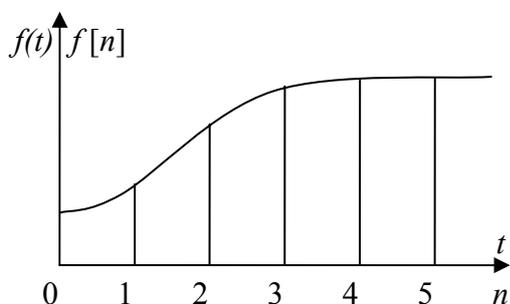
Рисунок 5.3 - Непрерывная функция  $f(t)$  и соответствующая решетчатая функция  $f[n]$
