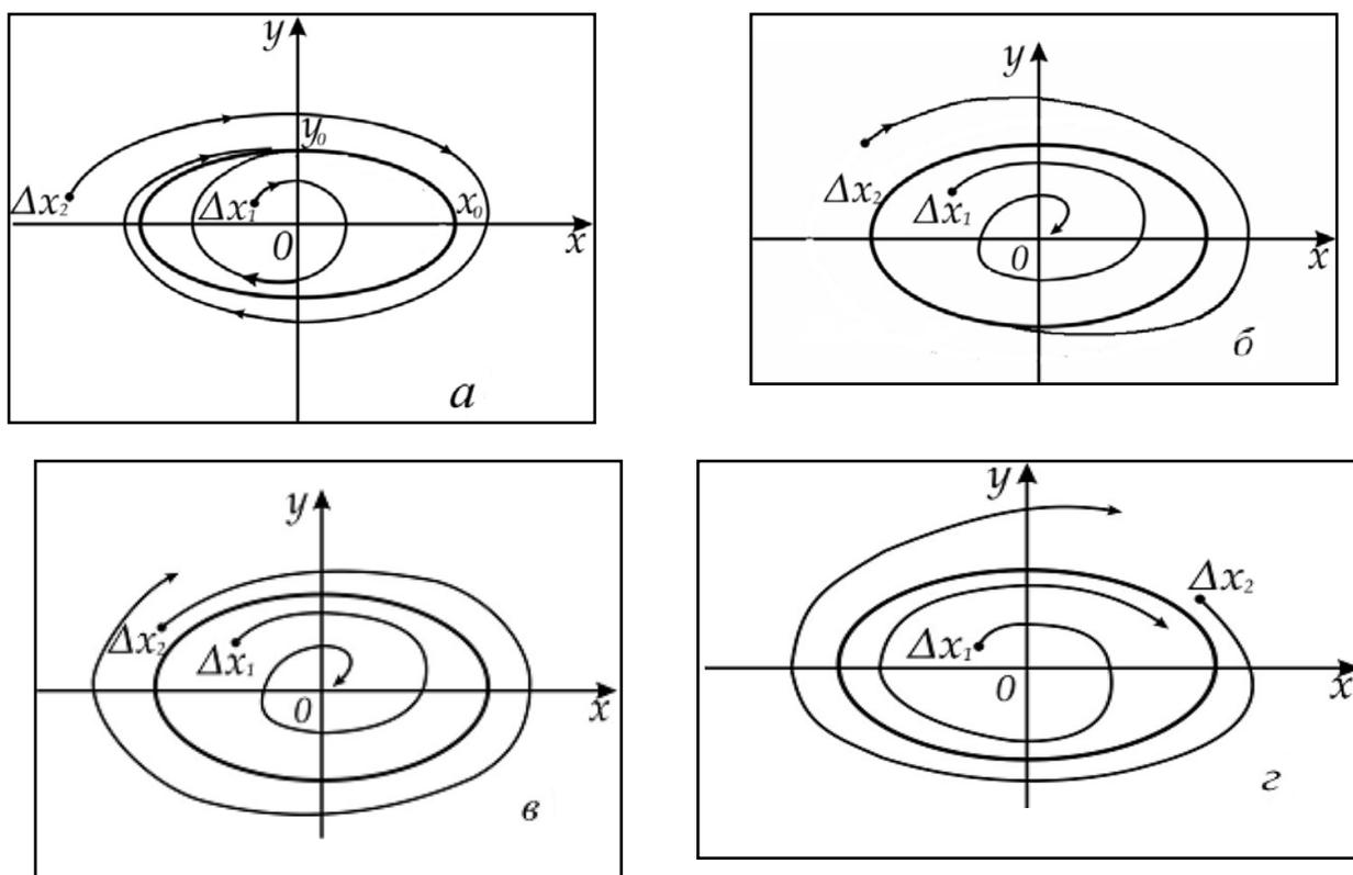
Рисунок 6.7 – Предельные циклы фазовых траекторий
