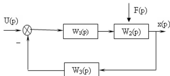
$W_3(p)$  – передаточная функция изменения положения поплавка в зависимости от уровня бензина;
