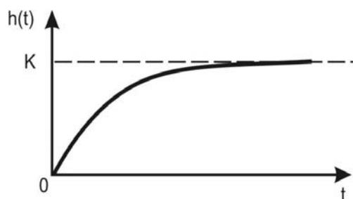
Рисунок 3.11 – График переходной функции апериодического звена
