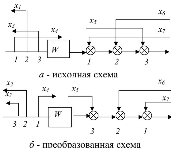
Рисунок 3.19 - Перераспределение сумматоров и узлов
