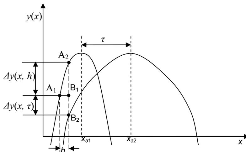
Рисунок 7.9 - Поиск экстремума при дрейфе экстремальной характеристики
