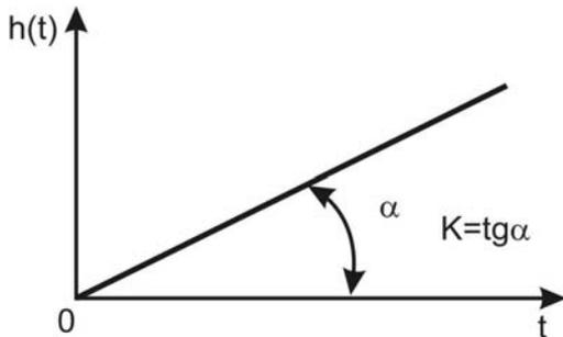
Рисунок 3.12 - График переходной функции интегрирующего звена
