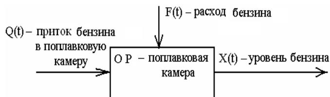
Рисунок 2.2 – Функциональная схема ОР и сигналы, воздействующие на него
