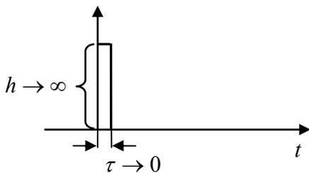
Рисунок 3.5 – Единичная импульсная функция
