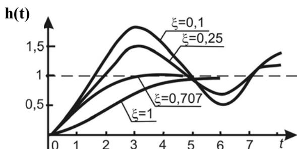
Рисунок 3.15 - Графики переходных характеристик колебательного звена
