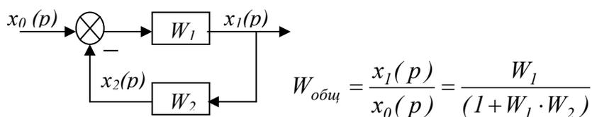
Рисунок 3.18 – Получение общей ПФ звена, охваченного отрицательной обратной связью
