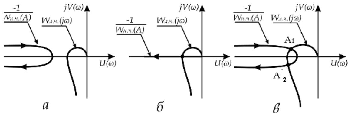
Рисунок 6.15 – Взаимное расположение АФЧ линейной части системы  $W_{л.ч.}(j\omega)$  и гармонически линеаризованной характеристики реле  $-1/W_{н.ч.}(A)$
