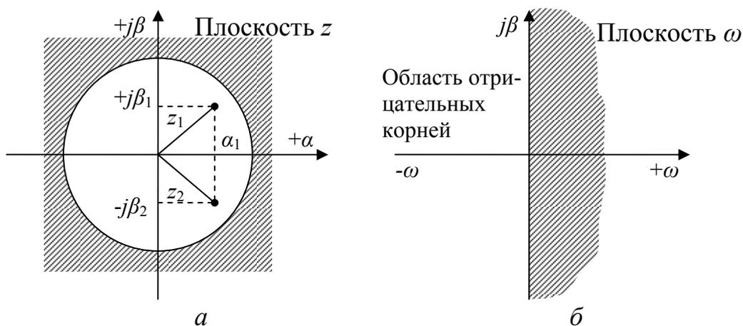
Рисунок 5.5 - Изображение корней замкнутой СИР на плоскости  $z$  и плоскости  $\omega$
