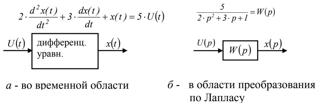
Рисунок 3.8 – Звено системы регулирования
