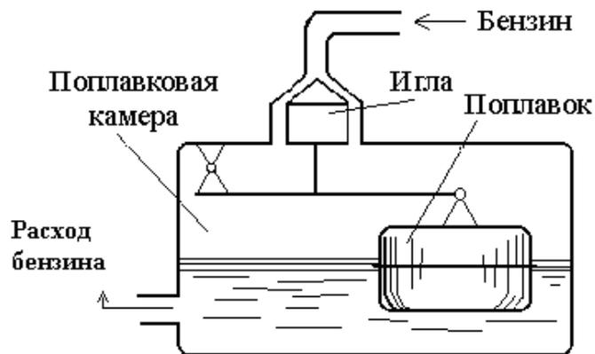
Рисунок 2.1 – Принципиальная схема системы регулирования уровня бензина в поплавковой камере
