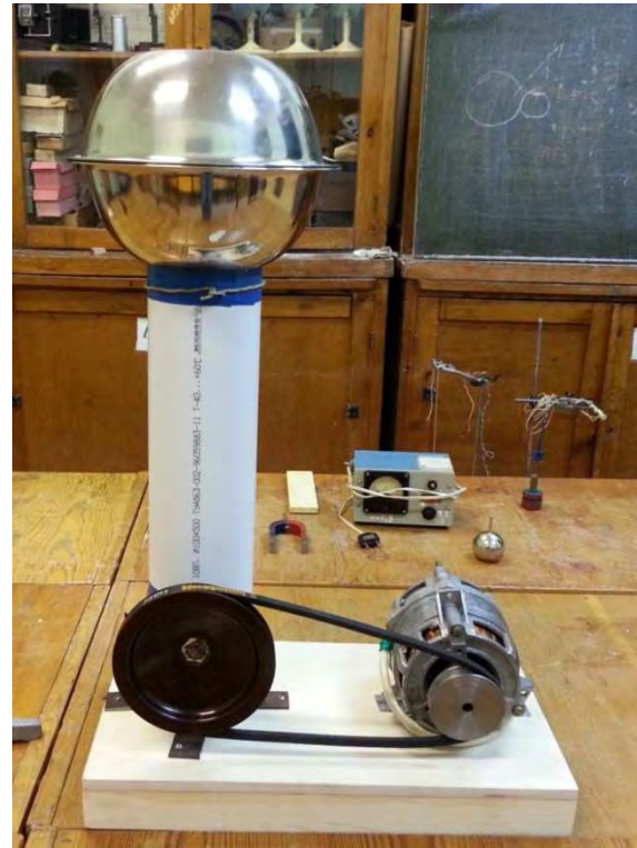
Рисунок 2 – Действующая модель генератора Ван де Граафа
