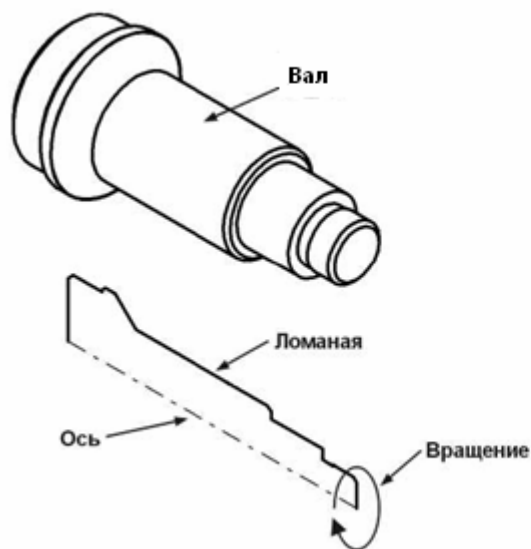
Рисунок 6.3 – Построение вала путем поворота
