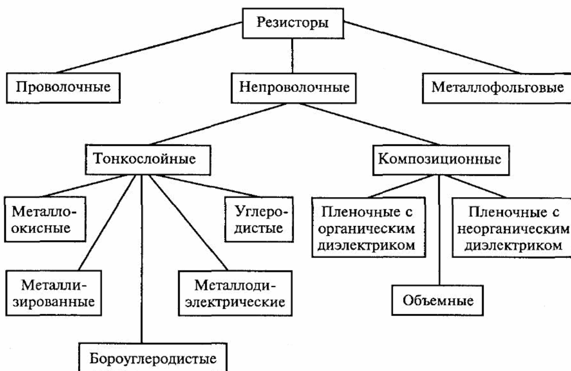
Рисунок 3 - Классификация резисторов по материалу резистивного элемента
