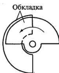
Рисунок 18 - Конструкция подстроечных конденсаторов
