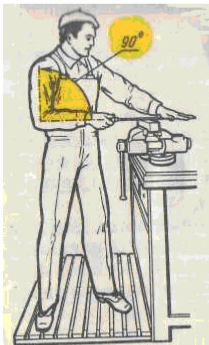
Рисунок 17 – Рабочее положение при опиливании
