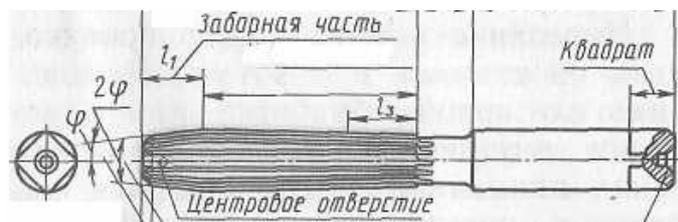
Рисунок 24 – Конические развертки
