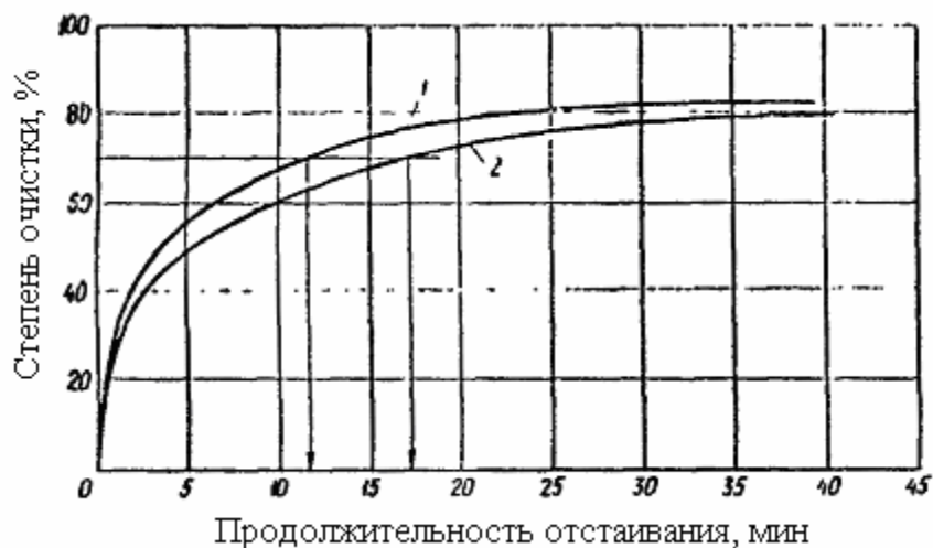
Рисунок 1 - Кинетика отстаивания сточных вод прокатного производства при исходной концентрации механических примесей C_0 = 200 мг/л в слое h , мм: 1 - 200; 2 - 500
