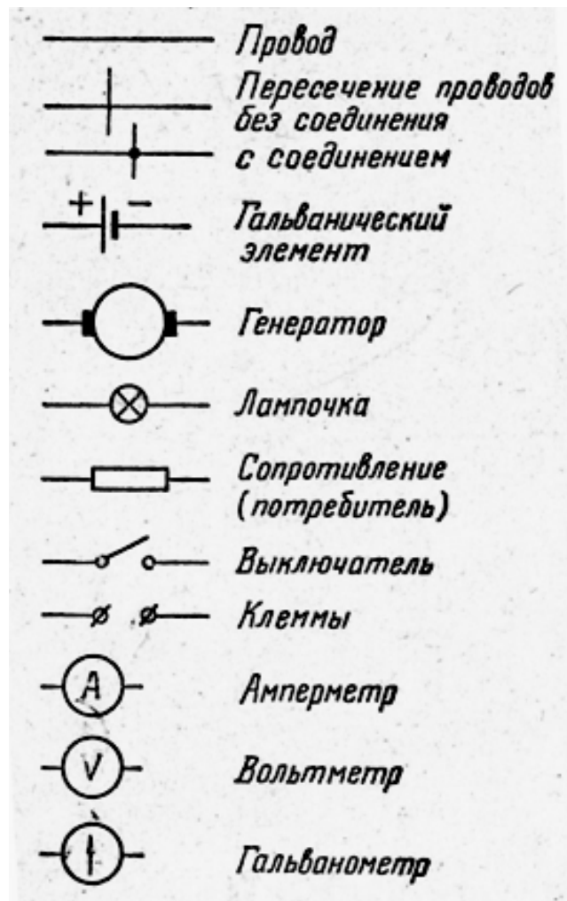
Рисунок 10 – Условные обозначения элементов электрических цепей
