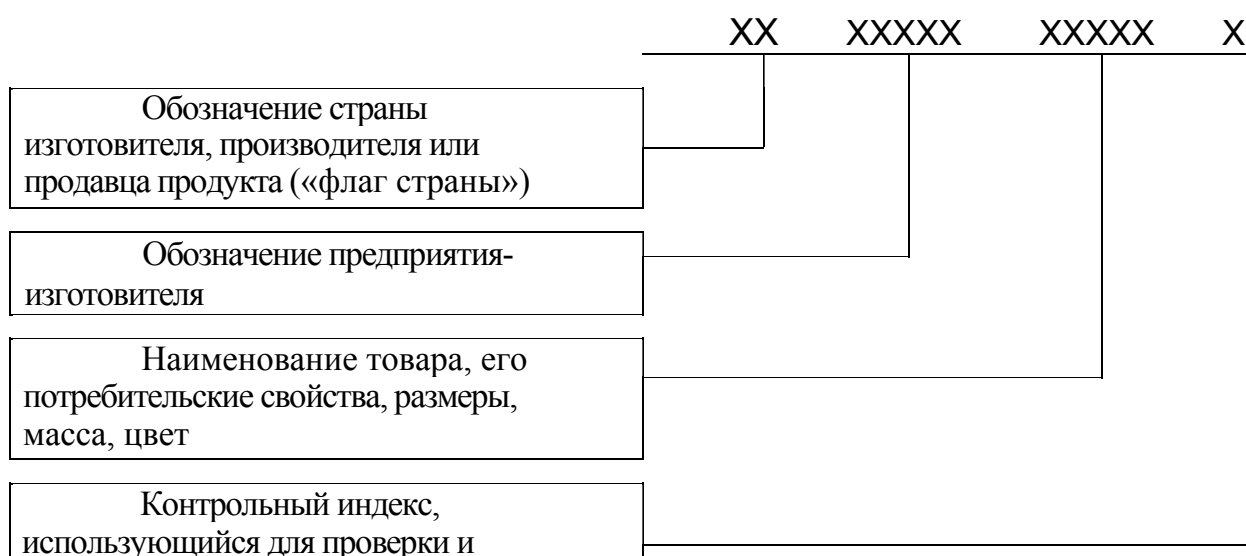
Рисунок 1 - Структура определения штрихового кода
