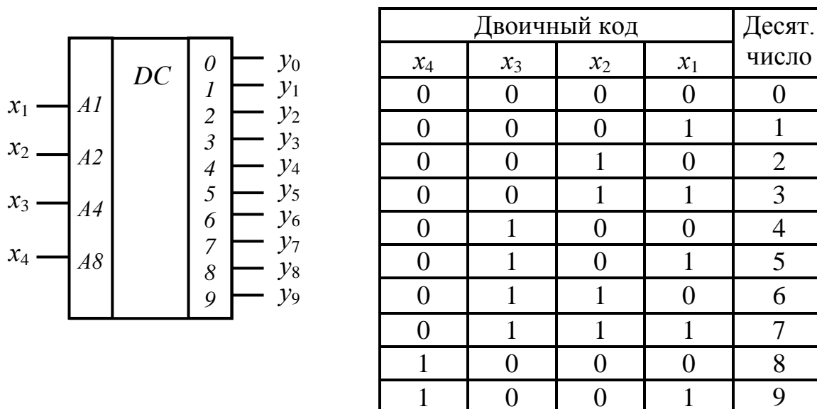
Рисунок 5.28 – УГО и таблица истинности дешифратора
