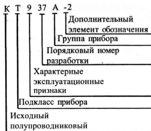
Рисунок 1.40 – Расшифровка обозначения транзистора
