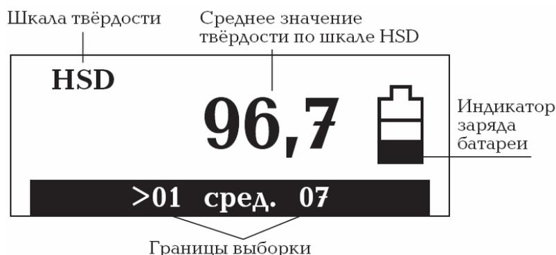
Рисунок 18 – Индикация дисплея в режиме «Калибровка»
