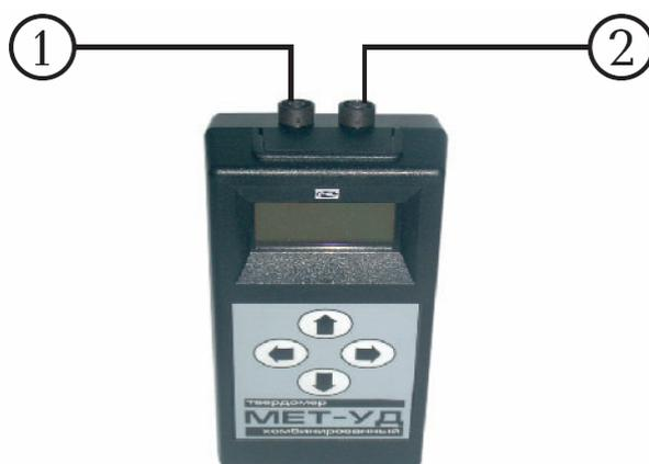
1 – гнездо четырёхштырькового разъёма для подключения зарядного устройства или компьютера; 2 – гнездо пятиштырькового разъёма для подключения датчика.
