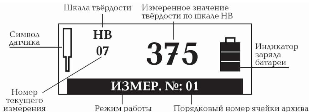
Рисунок 16 – Индикация дисплея в режиме «Измерение»
