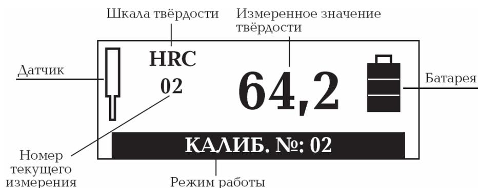
Рисунок 17 – Индикация дисплея в режиме «Калибровка»
