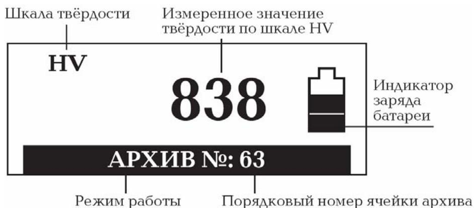
Рисунок 15 – Индикация дисплея в режиме «Измерение»
