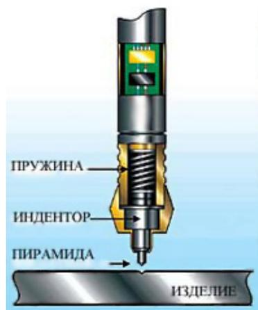
Рисунок 6 – Схема испытания на твердость акустическим методом
