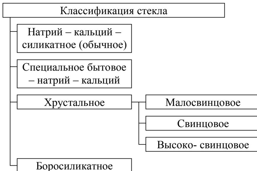
Рисунок 3 – Классификация стекла по химическому составу
