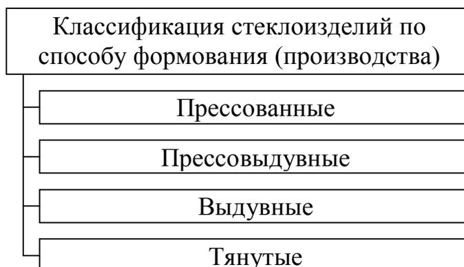
Рисунок 17 – Классификация стеклоизделий по способу формования
